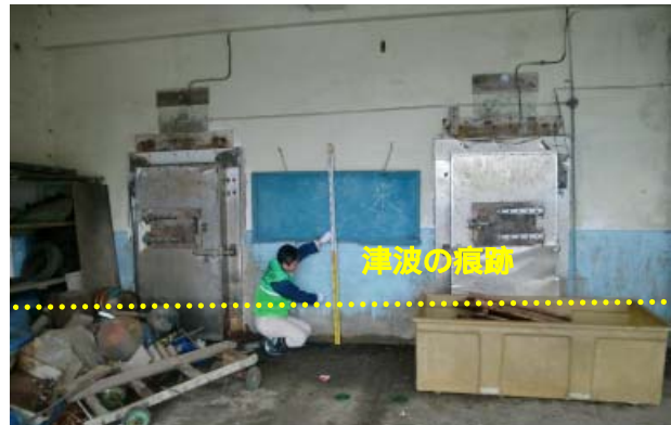
図 3 - 9 陸前高田市の現地調査の津波の痕跡
