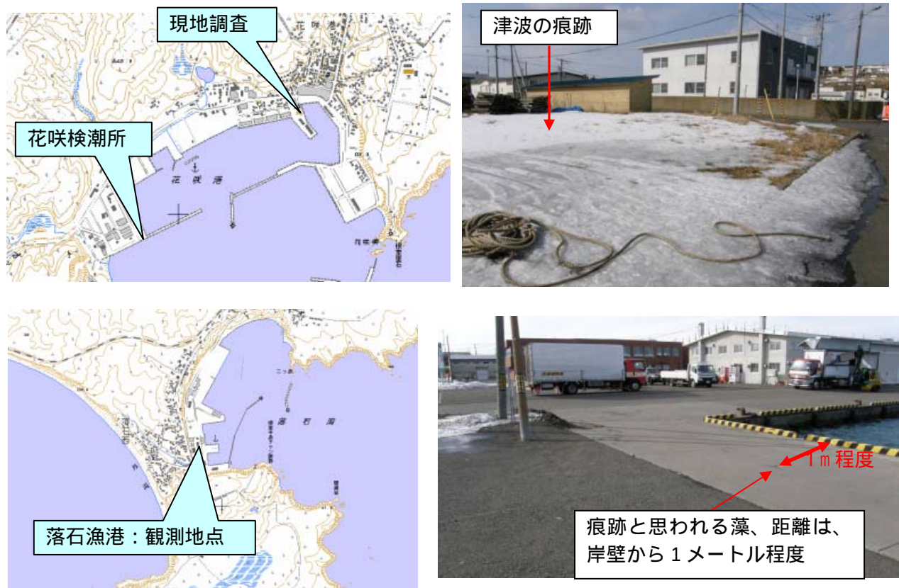
図 3 - 1 1 津波の高さを推定した地点の状況（上図：花咲港、下図：落石漁港）
