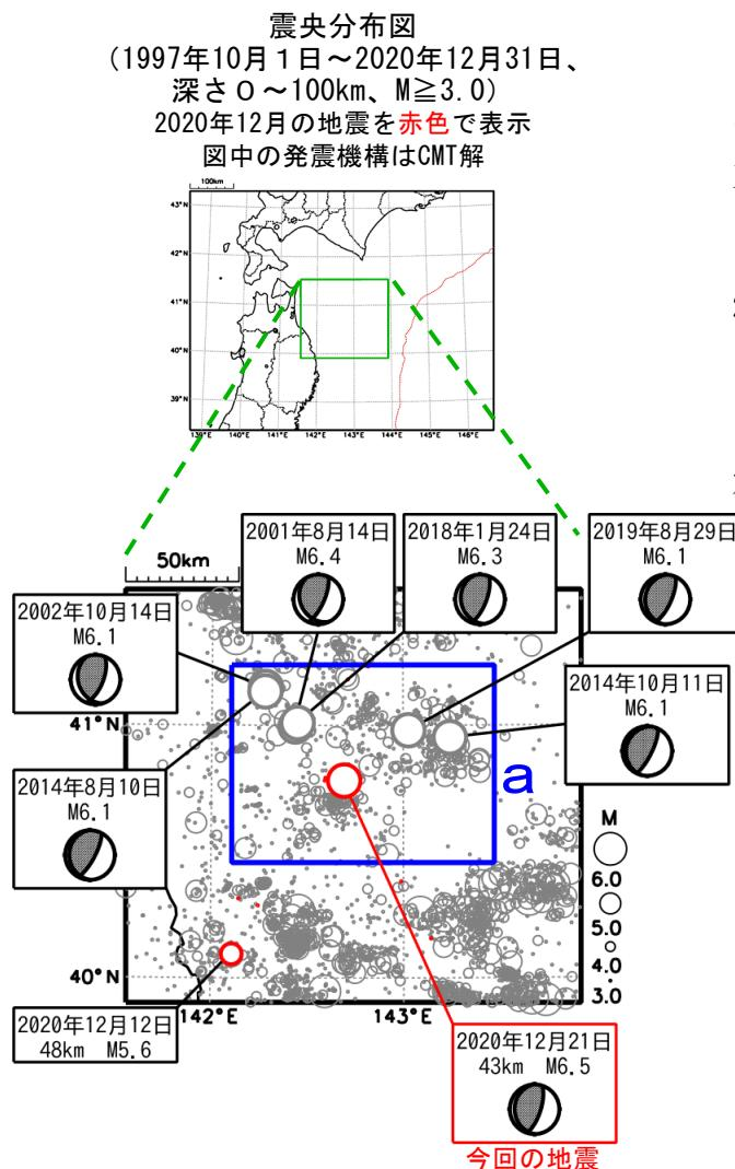
2020年12月21日02時23分に青森県東方沖の深さ43kmでM6.5の地震（最大震度5弱）が発生した。この地震は、発震機構（CMT解）が西北西～東南東方向に圧力軸を持つ逆断層型で、太平洋プレートと陸のプレートの境界で発生した。この地震により軽傷者1人の被害が生じた（12月28日現在、総務省消防庁による）。
